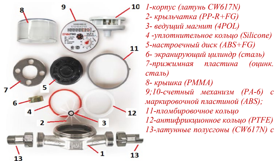
Рис.1 Конструкция счетчика в разобранном виде
